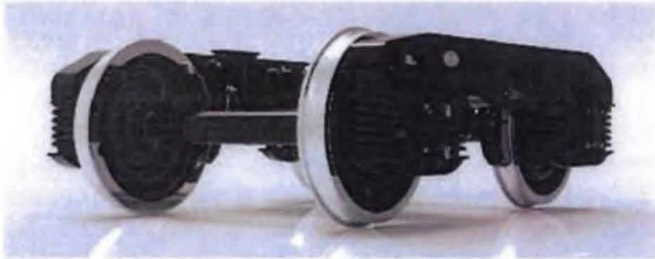
Görevi tekerleklerin hareketini sağlamak ve taşıtın geri kalan kısmını taşımaktır. Boji'ler demiryolu taşıtlarına daha iyi sürüş özellikleri sağlamak, rayda daha az aşınmaya yol açmak ve daha az raydan çıkma tehlikesi sunmak ile yükümlü bileşendir.
